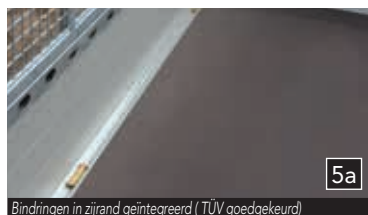
Bindringen in zijrand geïntegreerd (TUV goedgekeurd)
